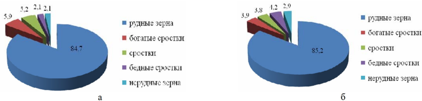
Рис. 1 – Раскрытие минеральных зерен в концентрате пробы 1 (а) и пробы 2 (б)
